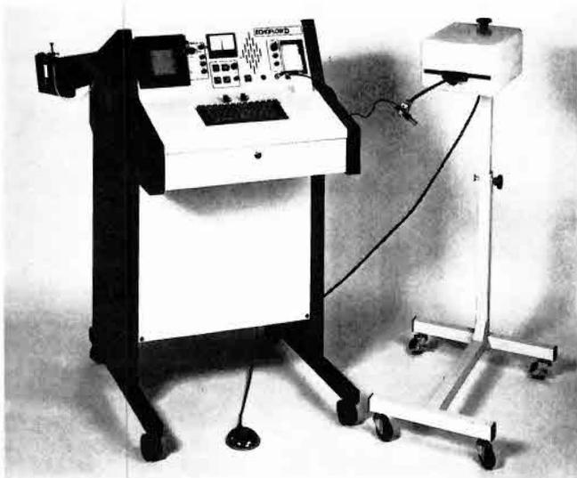
**Abb. 1** Das Doppler-Echoflow-Gerät.
